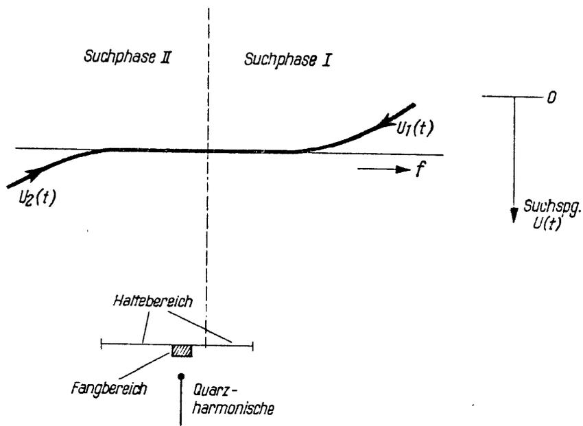
Bild 5 Spannungs- und Frequenzverlauf beim Suchvorgang
